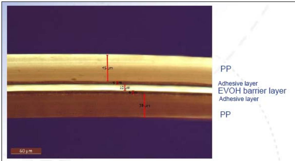
Figura 5: Estructura multicapa de una etiqueta IML barrera.
